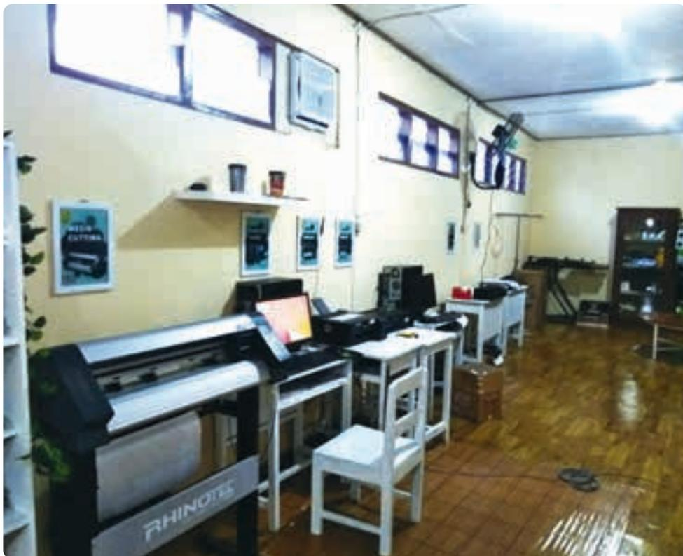
**Gambar 2.14** Sirkulasi udara dengan pemasangan *exhaust fan* dan pengaturan titik lampu menambah kenyamanan ketika bekerja.
