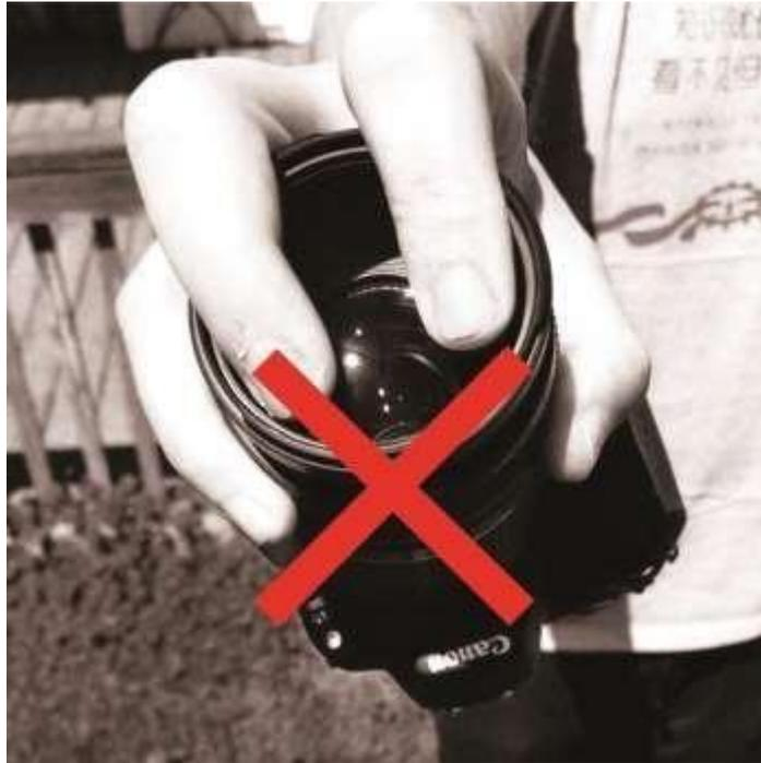
**Gambar 2.14.** Jangan pernah menyentuh bagian kaca lensa kamera dengan jari tangan kalian secara langsung.
