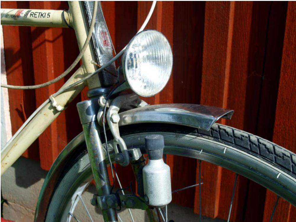
Gambar 1. 1. Dinamo dan lampu sepeda
