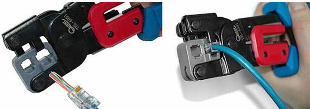
Gambar 4. 14 tang crimping saat memasang konektor
