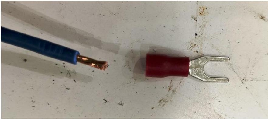
Gambar 4. 34 arah pemasangan kabel ke skun
